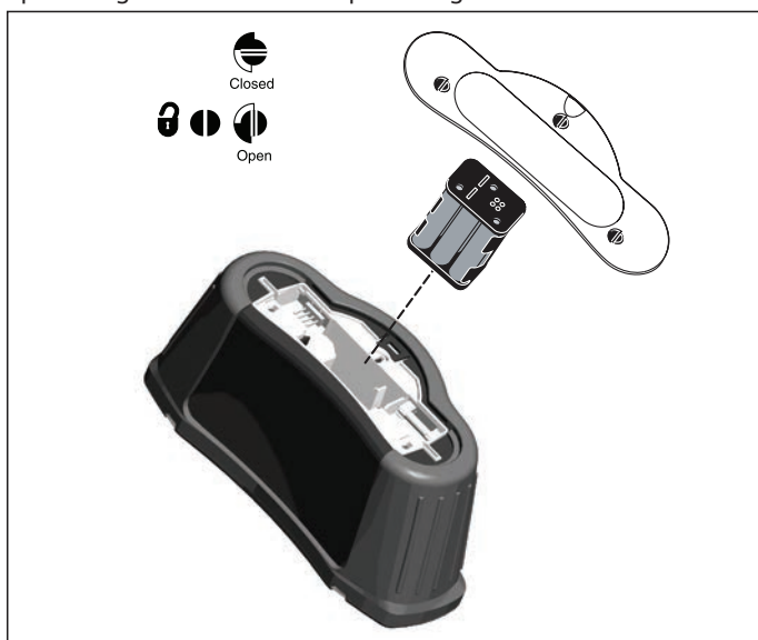
Figura 24. Sostituzione delle batterie
