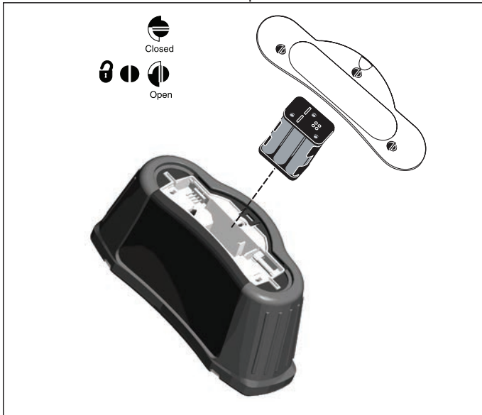
Figure 24. Remplacement des piles
